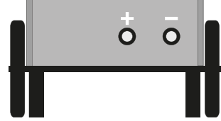
Şekil 3 : Kaynak ve Toprak Kablosu Soketleri
